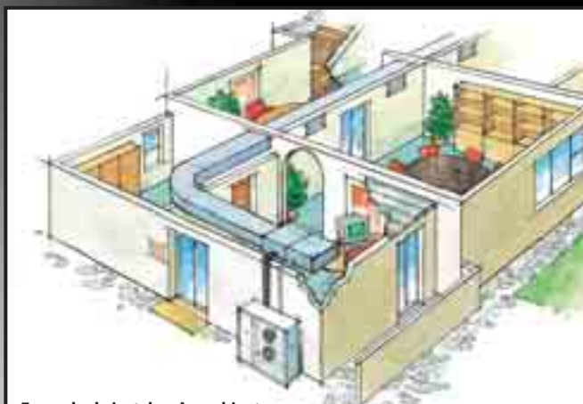
Exemplu de instalare în ambient rezidențial cu unități terminale canalizate tip Terموventilatoare (Seria TPM Tecnoclima)
